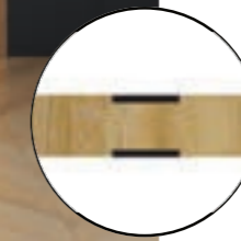
Sklo lacobel vlepene do hdf dosky (6mm hrubá hdf). Zarovnané s povrchom krídla.
